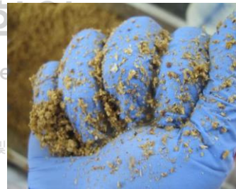
혼합 후 함수율 측정
